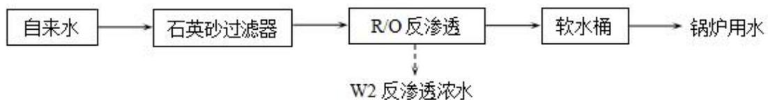
**图 2-3 软水制备工艺流程图**
